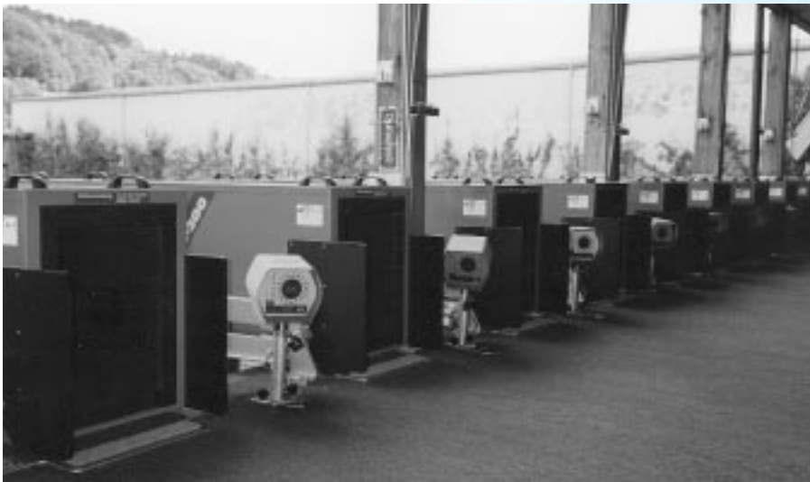
Abb. 1: Lärmschutz-tunnels auf den Lägern eines Schiessstandes
